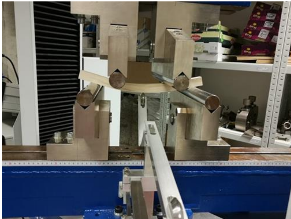
Obrázek 4. Zkouška modulu pružnosti jako součást experimentu statické pevnosti v ohybu.
