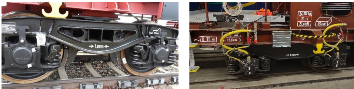
Obrázok 3. Podvozok s dvojkolesím nákladných vozňov vyrábaný v Tatravagonke a podvozok výspyného vozňa s pripevneným radiálnym piestovým čerpadlom na podvozku nemeckej výroby.
