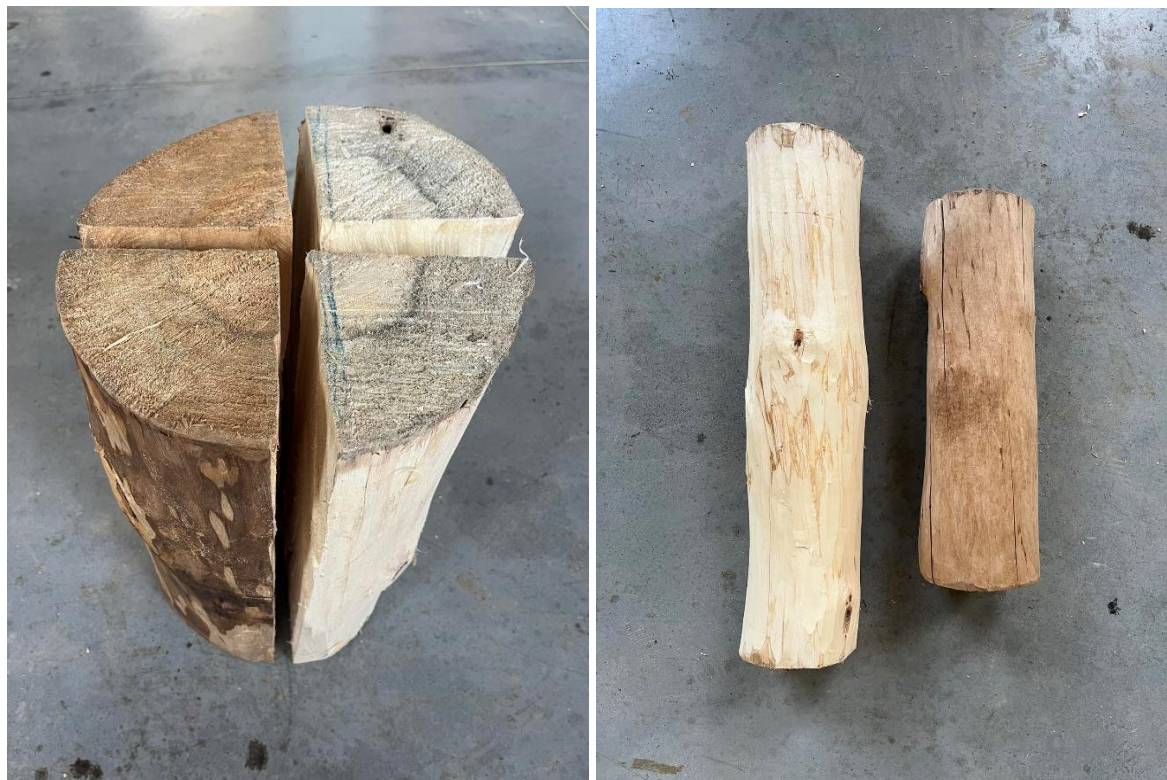
Obrázok 7. Termicky upravené dřevo topolu (vlevo) a jeřábu (vpravo).
