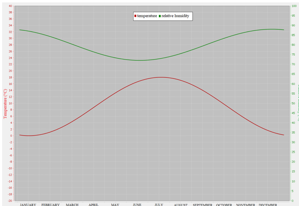
Obrázok 3. Vonkajšie okrajové podmienky (WUFI Databáza - Fraunhofer IBP).
