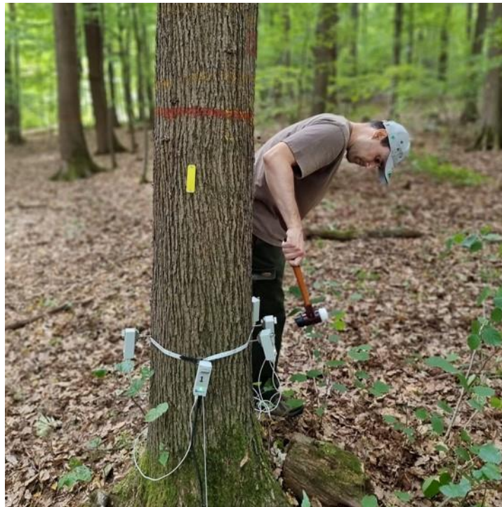
Obrázok 1. Vybudzovanie akustickej vlny po rozmiestnených senzorech tomografu ARBOTOM
