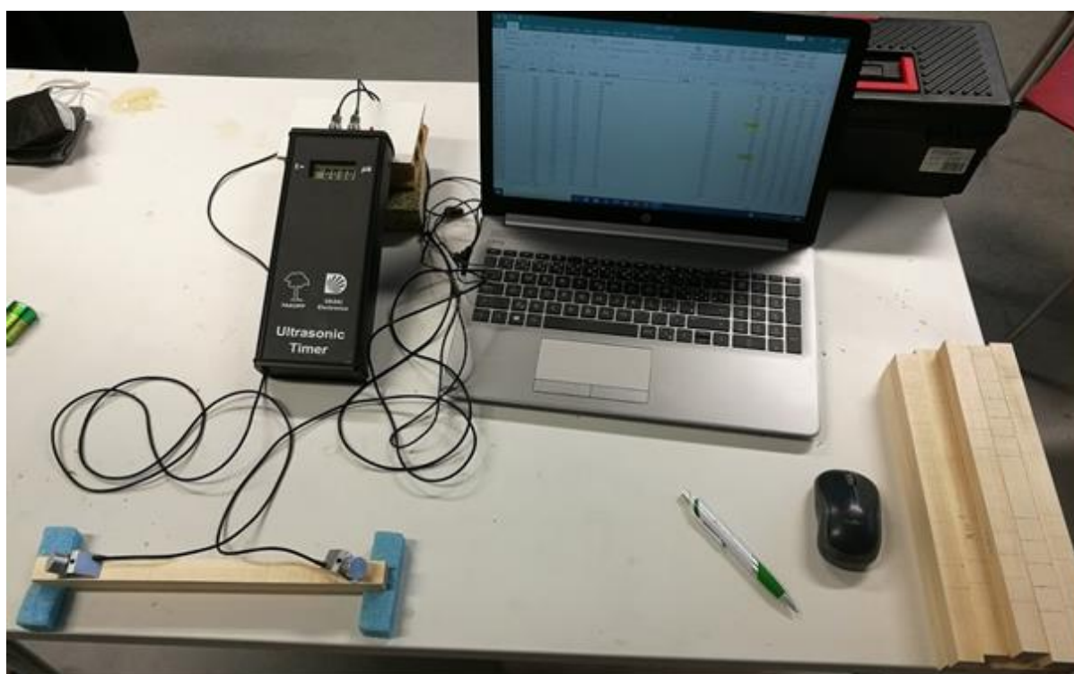
Obrázek 3. Měřicí aparatura ultrazvukové metody.
