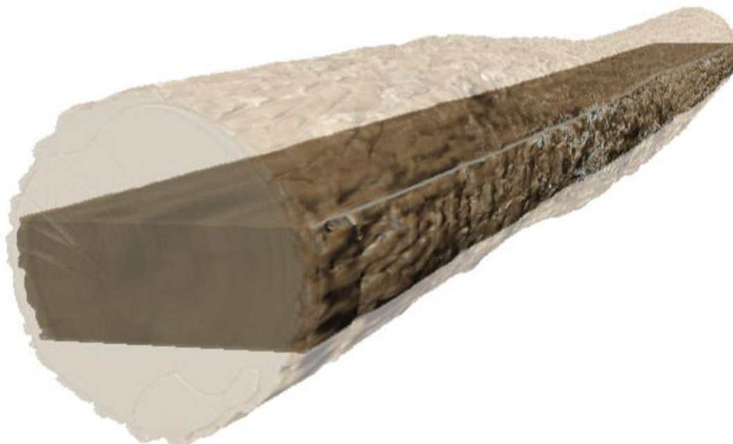
Obrázok 10. 3D model zobrazujúci guľatinu a vybrané rezivo v danom výreze.
