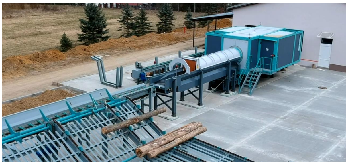
Obrázok 1. Sústava dopravníkov a 3D CT skener (kontajner).
