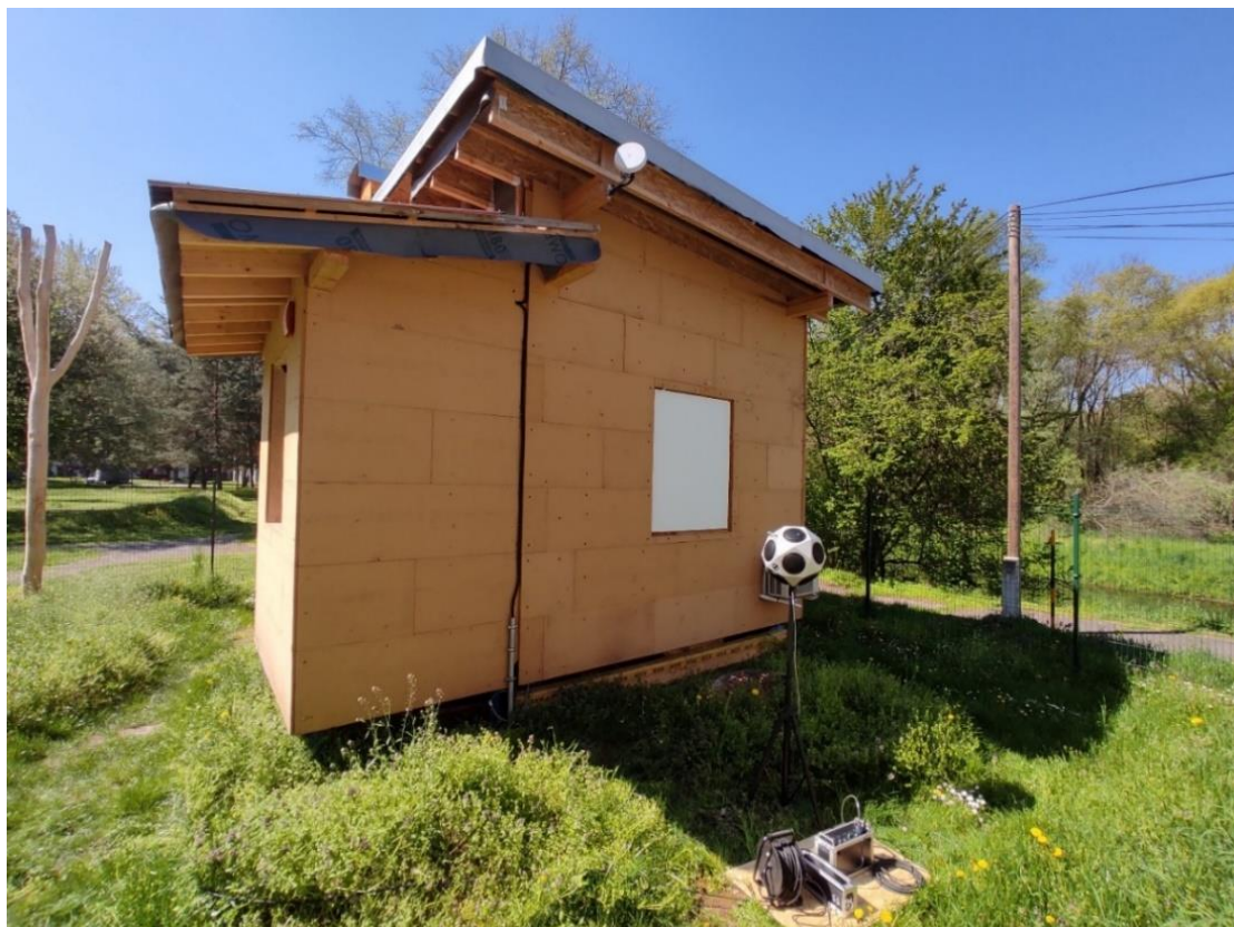
Obrázok 2. Pohľad na meranie nepriezvučnosti vonkajšej steny, časti obvodového plášťa skúmaného objektu KDS.
