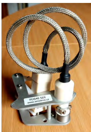
Obrázok 6. Mikrodendrometer – prístroj na meranie prírastku a zmien obvodov kmeňov malých priemerov: hore ukážka datalogra na automatizovaný záznam údajov (GreyBox N2N GSM), dole prírastkomerný senzor (model PDS-40S)
