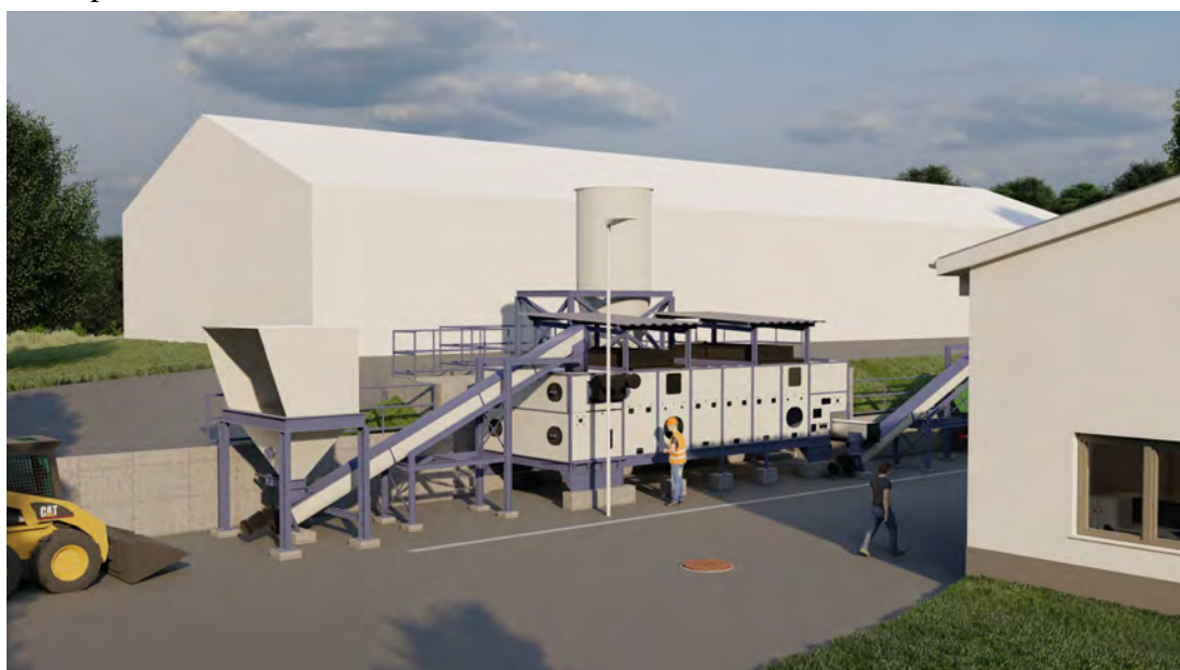
Obrázok 3. Sušička palivovej lesnej štiepky – Biologická základňa stráž
