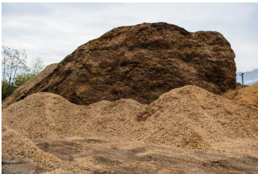
Obrázok 3. Príklad skladovania palivových drevných štiepok na veľkých hromadách. Zmena sfarbenia štiepok vnútri hromady naznačuje ich postupnú degradáciu spôsobenú vplyvom mikroorganizmov (Gergeľ 2019).
