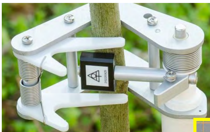
Obrázok 6. Mikrodendrometer – prístroj na meranie prírastku a zmien obvodov kmeňov malých priemerov: hore ukážka datalogra na automatizovaný záznam údajov (GreyBox N2N GSM), dole prírastkomerný senzor (model PDS-40S)
