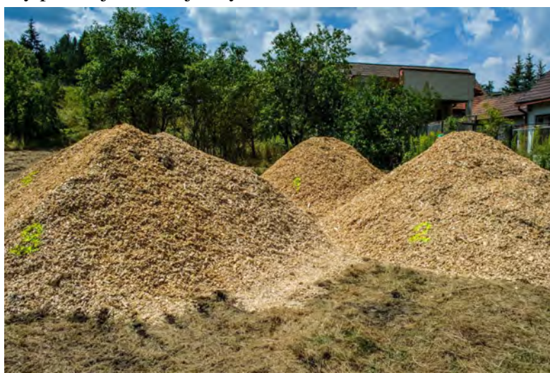
Obrázok 1. Testovanie troch druhov palivových drevných štiepok uložených na hromadách nekrtej skládky (Gejdoš, 2020).
