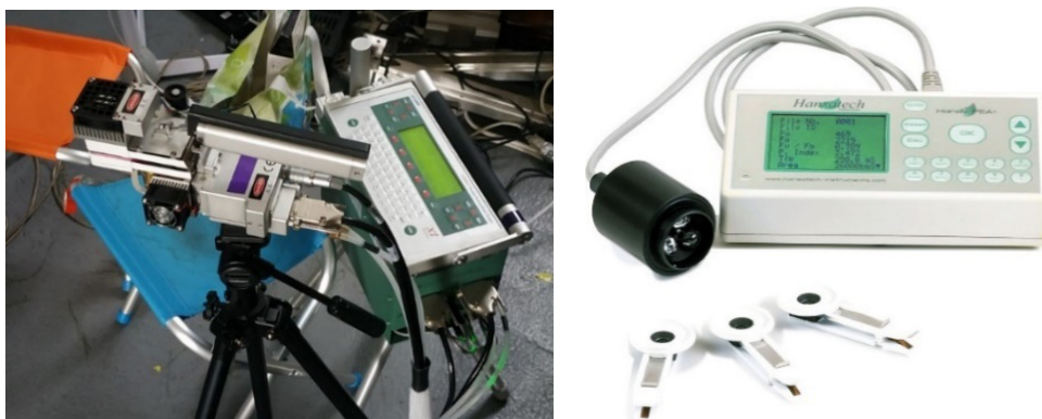
Obr. 3 Systém pre meranie výmeny plynov (vľavo) a fluorimeter na meranie fluorescencie chlorofylu (vpravo).
