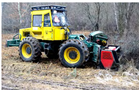
Prototyp drviča nežiaducich nárastov LD-2000 v rámci projektu APVV
