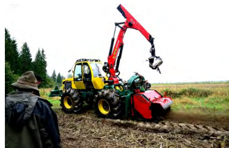
Prototyp adaptéra pôdnej frézy LF-1000 v rámci projektu APVV
