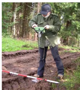
Meranie poškodenia lesnej cestnej siete penetrometrom
