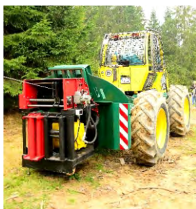
Prototyp adaptéra lanovkovej nadstavby LL200 v rámci projektu APVV
