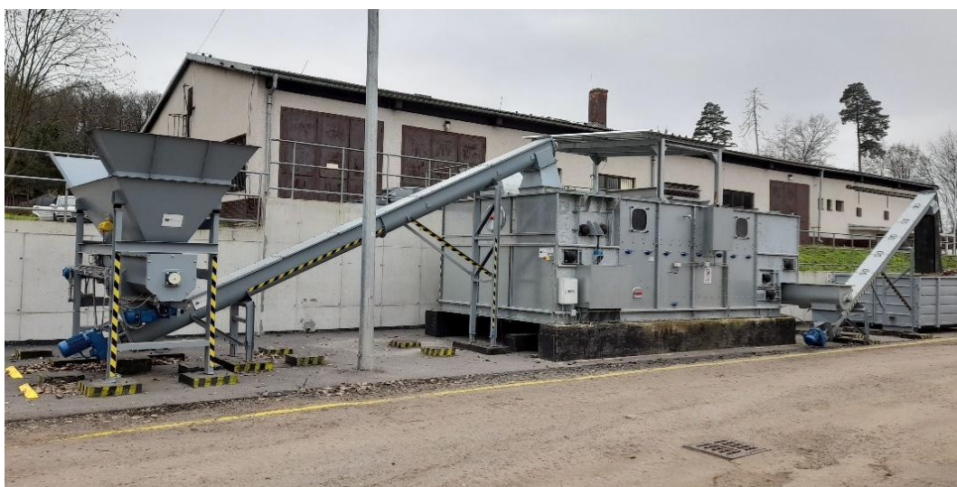
Obr. 1. Pásová sušiareň Katres KBD 3-4 vybudovaná v rámci BTP Stráž (Gergel' 2024)
