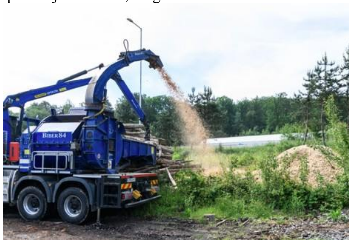
Obr. 2. Vírenie drevného prachu v procese štiepkovania dreva
