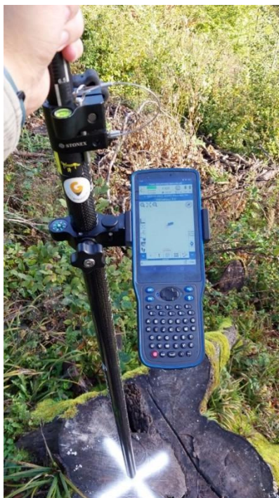
Obr. 2 Meranie kontrolných bodov pomocou GNSS prijímača Stonex s900+.
