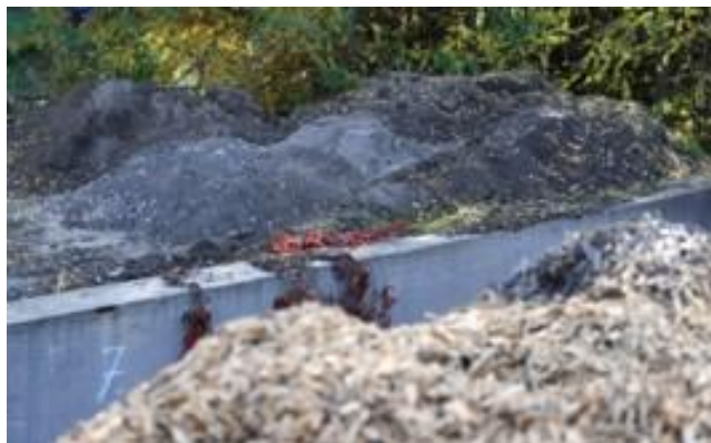
Obr. 4. Príklad nevhodného priestorového usporiadania – skladovaná hromada biomasy v blízkosti skládky popola
