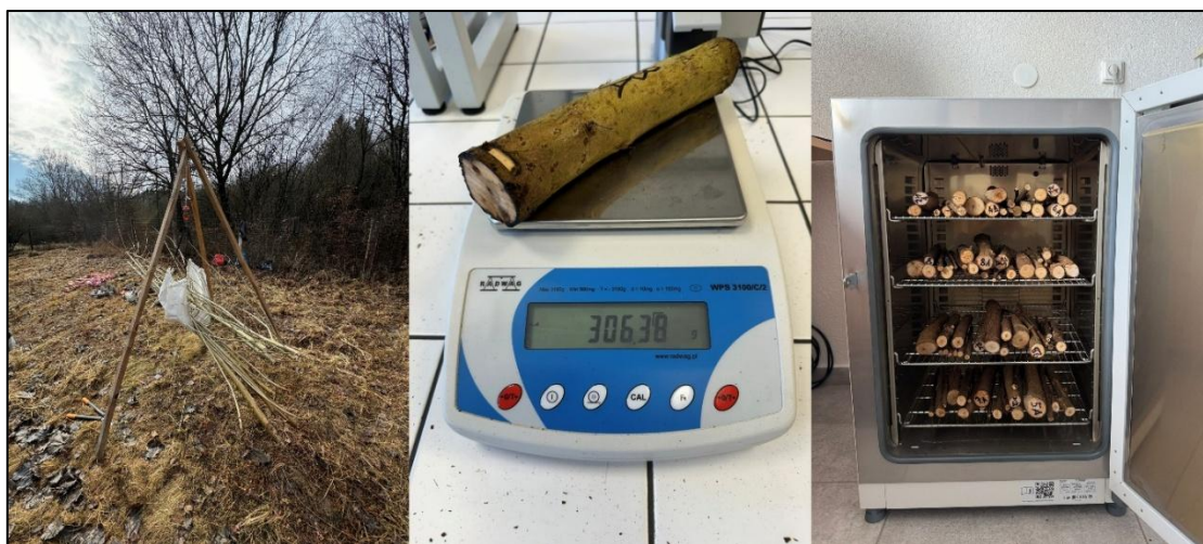
Obr. 3 vyťaženie výskumných plôch: Váženie priamo v teréne (vľavo), váženie vzoriek v laboratóriu (uprostred) a sušenie vzoriek (vpravo)
